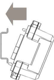
Per il montaggio del dispositivo, inserire il supporto di montaggio nell'apposito profilo sagomato dell'interfaccia, poi agganciare i dentini alla guida profilata partendo dal basso. Infine, spingere la parte superiore verso la guida per l'aggancio definitivo.
