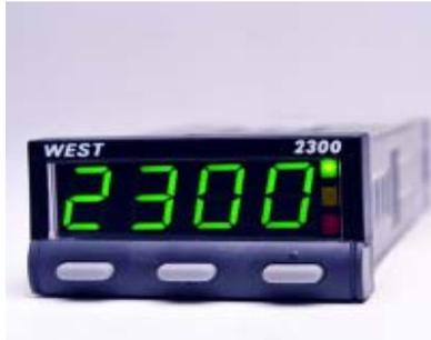
Den West 2300 gibt es als Anzeiger und als Regler. Kleines Format heißt nicht weniger Ausstattung, sondern eine 10 mm hohe Display, 2 A Schaltrelais und 3-Leiteranschluss für Pt 100. Ferner bietet der Regler unseren automatischen „Easy Tune“ PID-Algorithmus.
