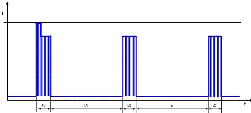
Erster Puls  $t_5$  typisch 0,7s (0,5 .. 1,0s) gefolgt von  $t_4$ . Danach zyklisch  $t_3/t_4$ .
