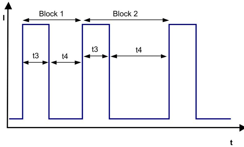
Block1: spezieller Blockierschutz 5 Zyklen  $t_3 / t_4 = 0,6 \text{ s} / 0,5$  Block2: Blockierschutz  $t_3 / t_4 = 0,6 \text{ s} / 10 \text{ s}$
