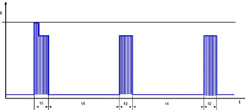
Erster Puls t<sub>5</sub> typisch 1,6s (1,3 .. 1,9s) gefolgt von t<sub>4</sub>. Danach zyklisch t<sub>3</sub>/t<sub>4</sub>.
