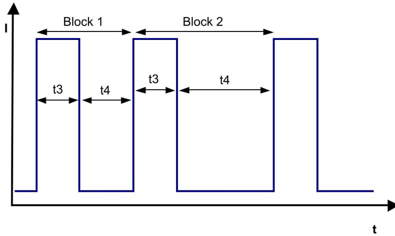
Block1: spezieller Blockierschutz 5 Zyklen  $t_3 / t_4 = 0,6 \text{ s} / 1 \text{ s}$  Block2: Blockierschutz  $t_3 / t_4 = 0,6 \text{ s} / 10 \text{ s}$
