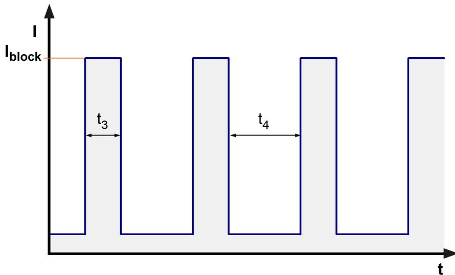
Der Lüfter verfügt über einen speziellen Blockiertakt. Dieser verhält sich bei blockiertem Lüfter während des Starts geringfügig anders als bei einer Blockierung aus dem laufenden Betrieb heraus. Die nachfolgenden Abbildungen beschreiben das Verhalten.
