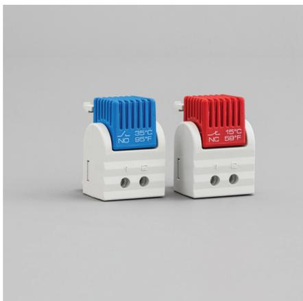
**Beschreibung:** Voreingestelltes Thermostat zur Regulierung von Temperaturen in Schaltschränken. Sensor thermostatisches Bimetall. Grundeinstellung geschlossen, rot (EFR202) zur Regulierung von Heizungen. Grundeinstellung offen, blau (EFR201) zur Regulierung von Filterlüftern, Wärmetauschern oder Anzeigemodulen. Montage-Clip für 35 mm DIN-Schiene (EN60715).
