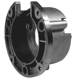
Eine sehr einfache und preiswerte Montage für alle Drehgeber mit einem Synchroflansch bietet die Montageglocke MOGL 5038. Die in Spritzgießtechnik aus glasfaserverstärktem Kunststoff gefertigte Montageglocke wirkt thermisch und elektrisch isolierend. Der Drehgeber wird wahlweise mit 3 Schrauben M4 x 10 DIN 912 oder mit 3 Befestigungsexzentern auf die Glocke montiert.
