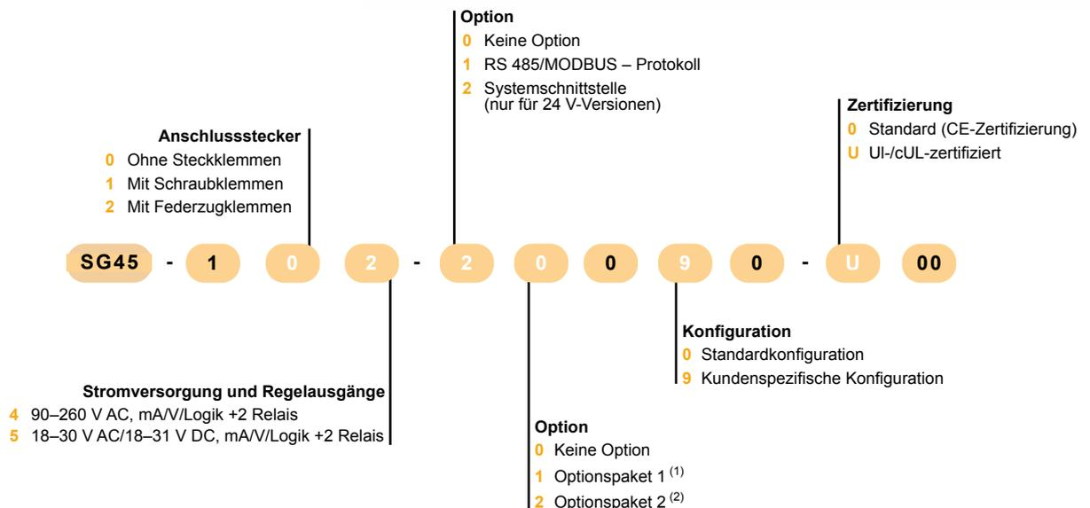
(1) Optionspaket 1: zusätzlicher Universaleingang INP2 sowie: O2-Messung, Zählereingang, Funktionen Trieren, Abtasten und Halten sowie Integrator
